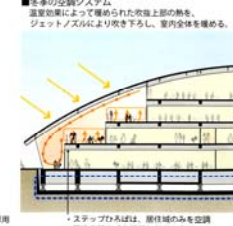
●冬季の空調システム 温室効果によって暖められた吹抜上部の熱を、ジェットノズルにより吹き下ろし、室内全体を暖める。
